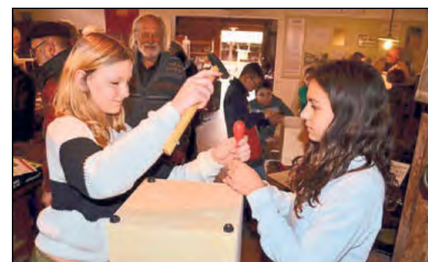
Damit der Klangkörper besser schwingen kann, schrauben Viola (10, links) und Chantal (11) kleine Füße auf die Unterseite des Instruments.
