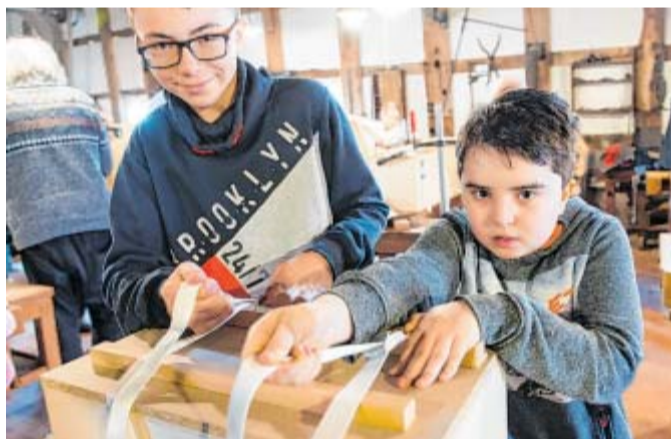
Krafteinsatz: Liam (links) und Luca ziehen die Riemen fest, mit denen das Cajon fixiert wird bis der Leim trocken ist.
